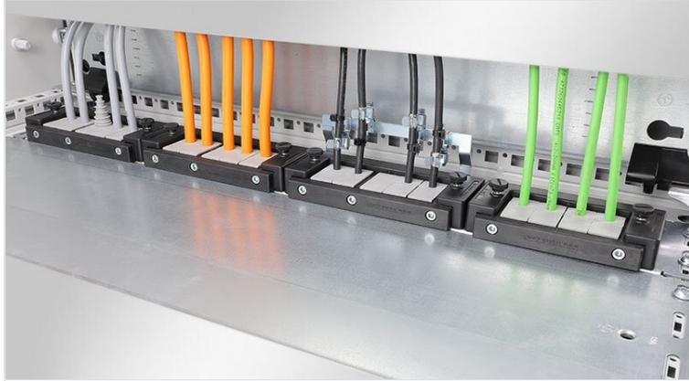
La plaque de fond KDR-ESR est une plaque de fond monobloc installée sur le bas de l'armoire électrique. Y sont préinstallés d'origine des glissières dans lesquels les cadres passe-câbles KEL-U et KEL-QUICK, après équipement, sont insérés et encliquetés d'une manière extrêmement simple.
